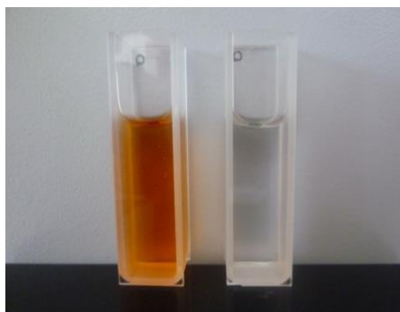
شکل ۱. فعالیت آنزیم پراکسیداز (نمونه سمت راست نمونه بدون عصاره آنزیمی و نمونه سمت چپ نمونه همراه با عصاره آنزیمی)
